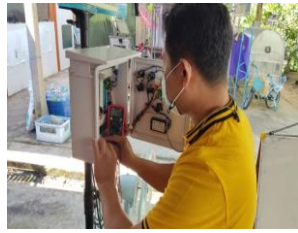
รูปที่ 2 การออกแบบและสร้างตู้ระบบควบคุมการวัดค่าอุปกรณ์ไฟฟ้าด้วยเทคโนโลยี IoT
