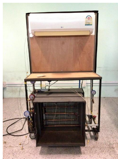
รูปที่ 1 ระบบปรับอากาศที่ติดตั้งอุปกรณ์แลกเปลี่ยนความร้อน
