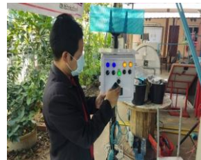
รูปที่ 5 ภาพรวมการทดสอบระบบควบคุมการวัดค่าอุปกรณ์ไฟฟ้า
