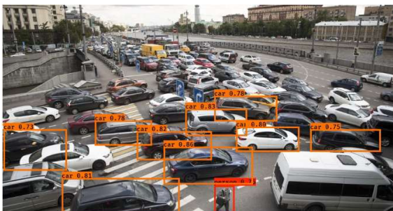
รูปที่ 2 การตรวจจับภาพวัตถุด้วยค่าคะแนนความมั่นใจ
