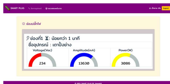
รูปที่ 18 เว็บแอปพลิเคชัน SMARTPLUG แสดงค่าแรงดันกระแสไฟฟ้าและระยะเวลาการใช้งานอุปกรณ์ไฟฟ้า
