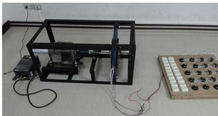
รูปที่ 5 การทดสอบเครื่องกำเนิดไฟฟ้าที่สร้างขึ้น
