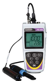
รูปที่ 5 เครื่องวัดออกซิเจนที่ละลายในน้ำ (DO Meter450)
