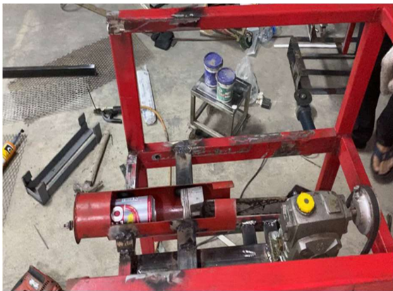
รูปที่ 8 การทดสอบการอัดและยุบตัวของกระป๋อง
