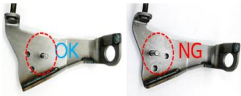
รูปที่ 4 จุดการประกอบโบลต์เข้ากับชิ้นงาน
