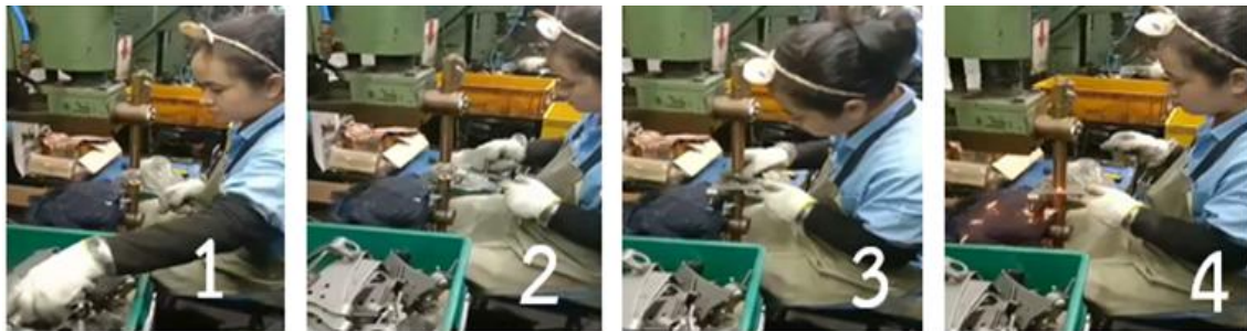
รูปที่ 3 ขั้นตอนการเชื่อมประกอบโบลต์ (Bolt) เข้ากับชิ้นส่วนแผ่นรองรับท่อน้ำมันเชื้อเพลิง
