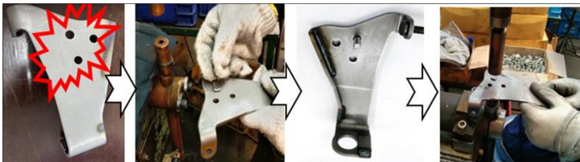
รูปที่ 5 การสังเกตการณ์ทำงานในสถานที่จริงขั้นตอนการใส่โบลต์เชื่อมจุด
