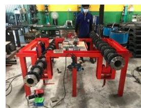
รูปที่ 11 การทดสอบใช้งานจริงของโต๊ะประกอบโรตารี
