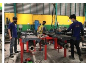
รูปที่ 11 การทดสอบใช้งานจริงของโต๊ะประกอบโรตารี
