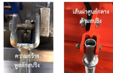
รูปที่ 15 ลักษณะปัญหาของสลักหูสปริง
