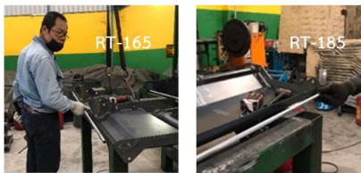
รูปที่ 14 อุปกรณ์ตรวจสอบระยะความยาวฝากระโปรงบน
