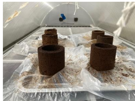
รูปที่ 6 ตากกระถางในตู้อบพลังงานแสงอาทิตย์
