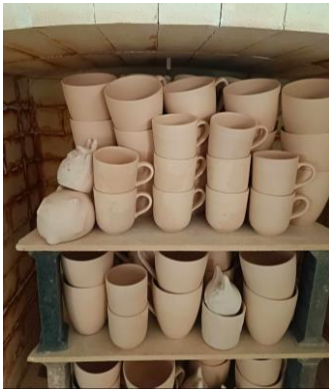
รูปที่ 14 ผลิตภัณฑ์หลังเผาดิบ (Biscuit firing)
