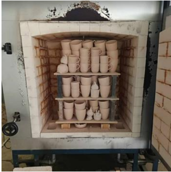
รูปที่ 8 การบรรจุชิ้นงานเซรามิกส์เพื่อเผาดิบ (Biscuit firing)
