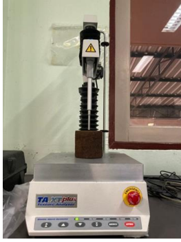
รูปที่ 8 การทดสอบการต้านทานแรงเฉาะด้วยเครื่อง Texture analyzer
