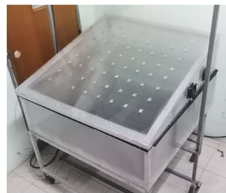
รูปที่ 3 ตู้อบแห้งพลังงานแสงอาทิตย์ชนิดหลังคาสามเหลี่ยม มุมฉากที่ติดตั้งครีบนำความร้อน
