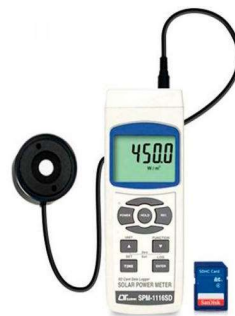
รูปที่ 5 เครื่องมือวัดค่าความเข้มรังสีแสงอาทิตย์รุ่น SMP-1116SD
