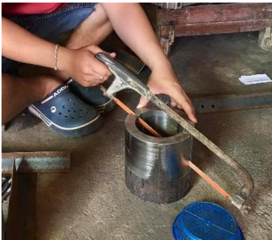
รูปที่ 4 การผ่าแบ่งครึ่งแม่พิมพ์
