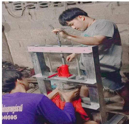
รูปที่ 9 ทดสอบการอัดขึ้นรูปกระถางต้นไม้
