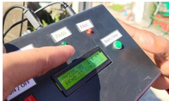
รูปที่ 10 ไฟแสดงสถานะที่ตำแหน่ง FAIL
