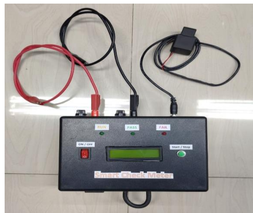
รูปที่ 5 เครื่องตรวจสอบมิเตอร์แบบอัตโนมัติที่สมบูรณ์จากรูปที่ 5 เป็นการแสดงภาพถ่ายเครื่องที่เสร็จสมบูรณ์
