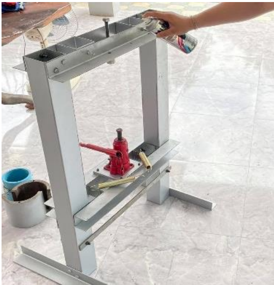
รูปที่ 8 เครื่องอัดไฮดรอลิกที่ประกอบเรียบร้อยแล้ว ทำการฉีคพ่นสีป้องกันการเกิดสนิม
