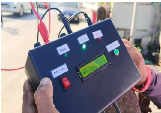
รูปที่ 9 ไฟแสดงสถานะที่ตำแหน่ง PASS
