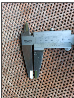
รูปที่ 3 แสดงการวัดขนาดของช่องตะแกรงคัดขนาด ละเอียด 4.40 มิลลิเมตร
