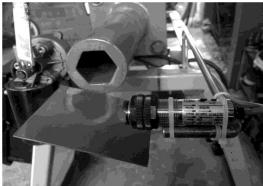
รูปที่ 3 การติดตั้งเซนเซอร์
