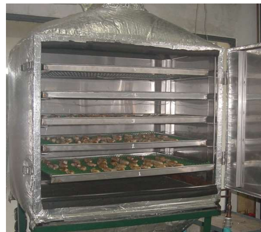
รูปที่ 3 ตู้อบและกล้วยที่กำลังทำการอบแห้ง
