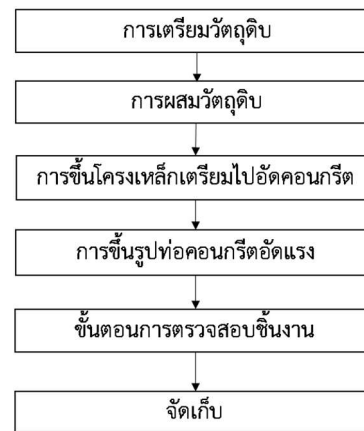
รูปที่ 2 ขั้นตอนการผลิตผลิตภัณฑ์คอนกรีตสำเร็จรูป
