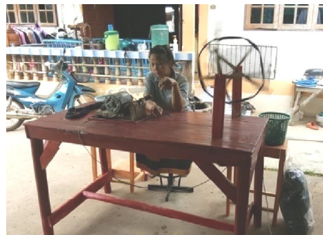
รูปที่ 1 การกรอด้วยยืนด้วยเครื่องกรอด้วยไฟฟ้า
