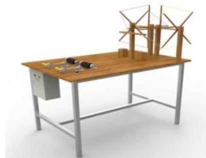
รูปที่ 2 เครื่องกรอตัดเย็บแบบดรัมสำหรับทอผ้าพื้นเมือง
