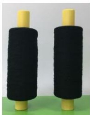
รูปที่ 5 ด้ายยืนที่กรอที่ความเร็ว 775 รอบต่อนาที (ซ้าย) และ 1,500 รอบต่อนาที (ขวา)
