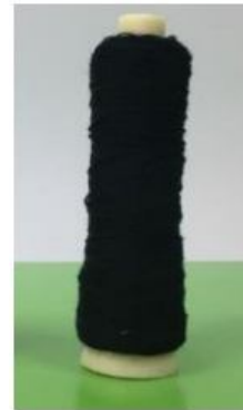
รูปที่ 4 ด้วยฟุ้งที่กรอที่ความเร็ว 1,500 รอบต่อนาที
