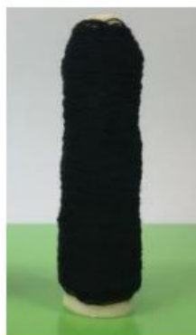
รูปที่ 3 ด้วยฟุ้งที่กรอที่ความเร็ว 775 รอบต่อนาที
