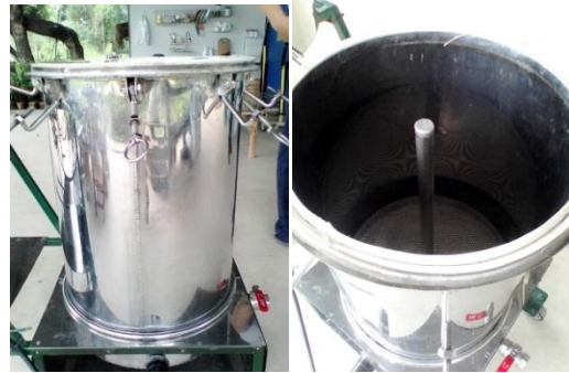
รูปที่ 1 หม้อต้มไอน้ำ
