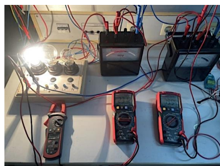
(ข) การวัดพารามิเตอร์ทางไฟฟ้ากับเครื่องมือวัด
