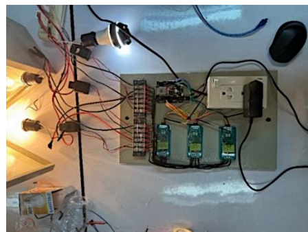
(ก) การวัดพารามิเตอร์ทางไฟฟ้ากับเซนเซอร์ PZEM-004T
