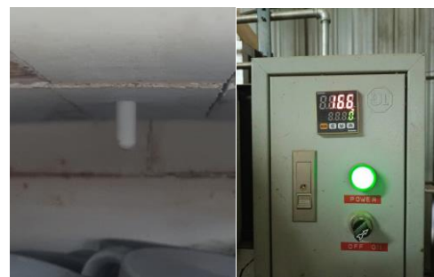
รูปที่ 4 Thermocouple และ หน้าจอแสดงผลอุณหภูมิภายในเตาเผาเซรามิกส์
