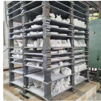
รูปที่ 10 ผลิตภัณฑ์ที่ผ่านการเขียนสีใต้เคลือบและชุบเคลือบใส่บรรจุเข้าเตาเผาเคลือบ
