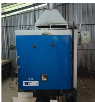
รูปที่ 9 เตาเผา (Biscuit firing kiln)
