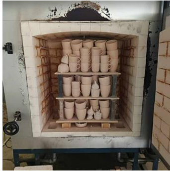
รูปที่ 8 การบรรจุชิ้นงานเซรามิกส์เพื่อเผา (Biscuit firing)
