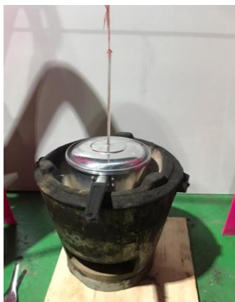
รูปที่ 8 การหาประสิทธิภาพการให้ความร้อนของถ่านอัดแท่งโดยการต้มน้ำ
