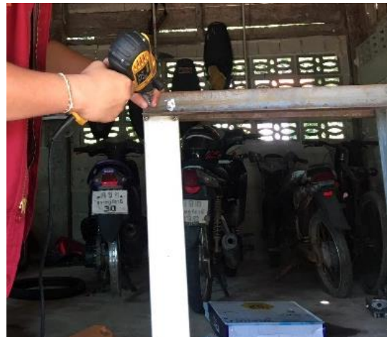
รูปที่ 6 โครงสร้างเครื่องเจาะและยึดด้วยน็อต
