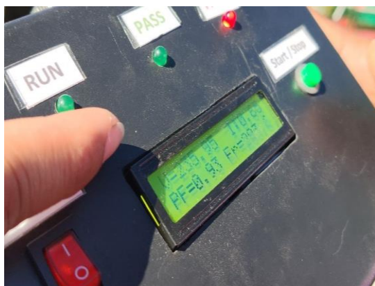
รูปที่ 8 วัดค่าทางไฟฟ้าจากเครื่องตรวจสอบมิเตอร์แบบอัตโนมัติ
