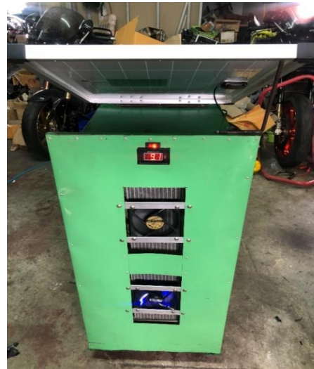
รูปที่ 9 การทดสอบการใช้งานของเครื่องแลกเปลี่ยนความร้อนจากพลังงานทดแทนด้วยพลังงานแสงอาทิตย์
