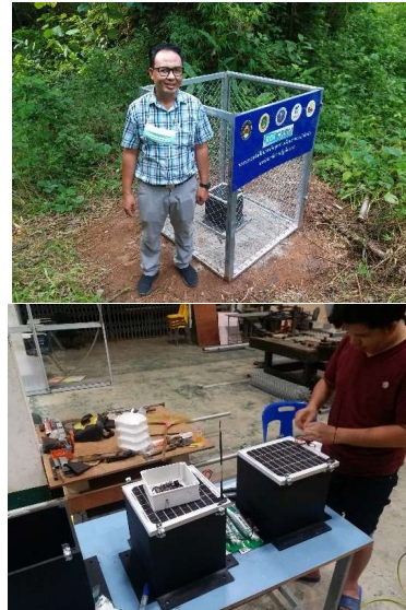
รูปที่ 10 แสดงอุปกรณ์เซ็นเซอร์ตรวจจับความร้อนจากการเกิดไฟป่าที่ติดตั้งใช้ในการทดสอบในงานวิจัย
