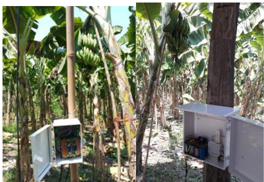
รูปที่ 12 การติดตั้งโหนดเซนเซอร์และโหนดฐาน
