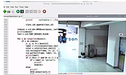
รูปที่ 18 การตรวจจับภาพบุคคลที่ระยะ 20 เมตร ของกล้อง 2
