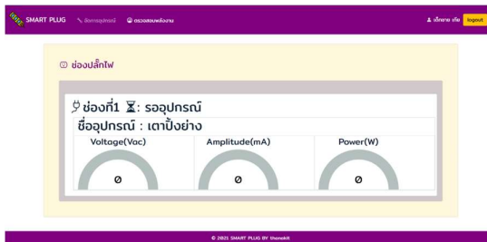
รูปที่ 19 เว็บแอปพลิเคชัน SMARTPLUG เมื่อถูกสั่งให้ตัดการจ่ายกระแสไฟฟ้าให้อุปกรณ์ไฟฟ้า
