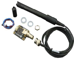
รูปที่ 4 แสดงเซนเซอร์ Dissolved Oxygen Sensor.
