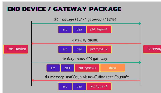
รูปที่ 7 รูปแบบการส่งของข้อมูลลอรา
