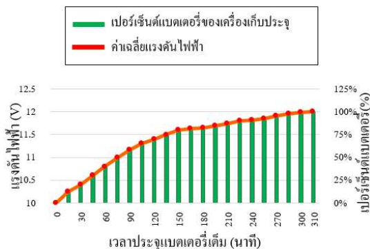
รูปที่ 18 การเทียบค่าเปอร์เซ็นต์แบตเตอรี่ของตัวเครื่องเก็บประจุผ่านการประจุด้วยอะแดปเตอร์
