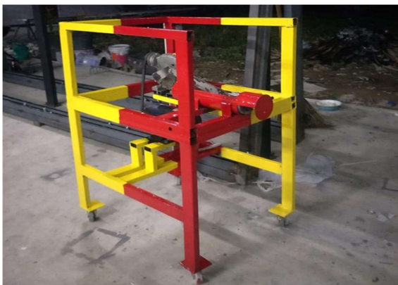
รูปที่ 9 การเครื่องอัดขวดพลาสติกและกระป๋องเหล็ก
