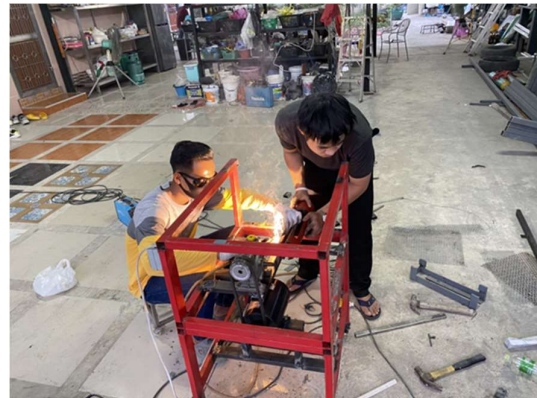
รูปที่ 6 การประกอบข้อเหวี่ยงและกระบอกสูบ
