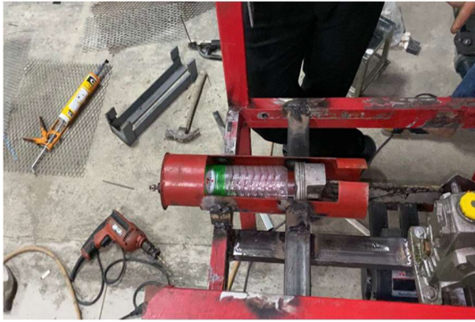
รูปที่ 7 การทดสอบการอัดและยุบตัวขวดพลาสติก
