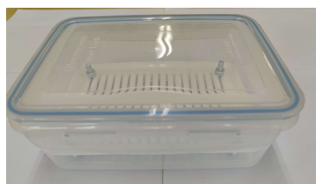
รูปที่ 1 กล่องพลาสติกแบบซูปเปอร์ล็อกบรรจุสารละลายเกลือสำหรับใส่กล้วยน้ำว้าในการทดลอง
