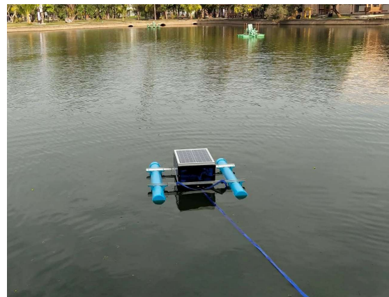
รูปที่ 10 ทดสอบการลอยน้ำของเครื่องต้นแบบ
