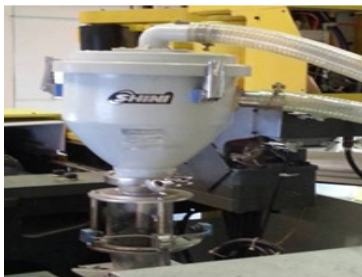
รูปที่ 4 ถังบรรจุเม็ดพลาสติก (Hopper) ก่อนการปรับปรุง
