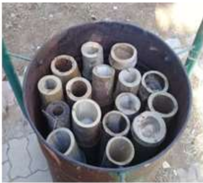
(ข) จัดเรียงไม้ไผ่ที่แห้งแล้วในเตาให้เต็มเตาเผา
