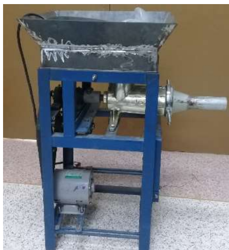
(ค) ชุดอัดถ่านดัดแปลงจากเครื่องบดหมู
