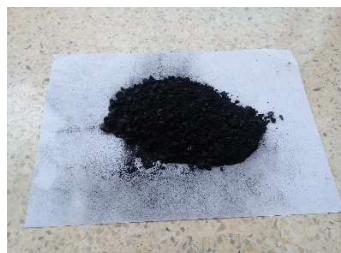
รูปที่ 6 ผงถ่านไม้ไฟที่ผ่านการบดด้วยเครื่องบด
