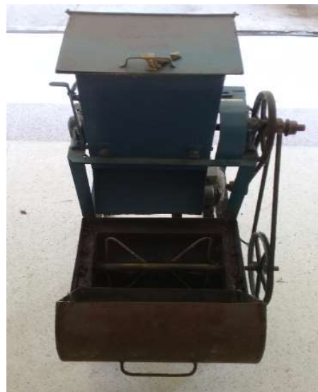
(ข) ชุดบดถ่านและผสมถ่านดัดแปลงจากชุดบดน้ำแข็ง
