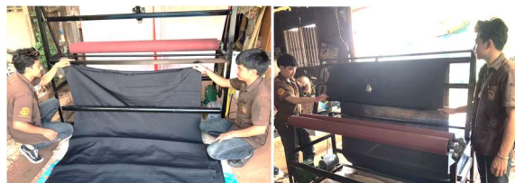
รูปที่ 5 การร้อยผ้าผ่านแกนเพลาลูกที่ 1, 2 และ 3
