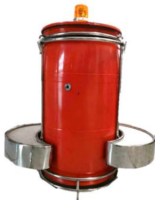
รูปที่ 5 ท่อนส่งสัญญาณขอความช่วยเหลือทางทะเล
