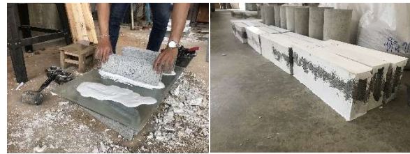
รูปที่ 3 การเตรียมตัวอย่างที่ใช้ในการทดสอบแรงอัด
