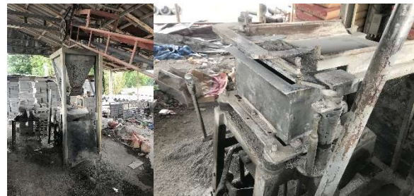
รูปที่ 1 เครื่องจักรและกระบวนการผลิตอิฐคอนกรีตในโรงงานผลิตอิฐคอนกรีตแห่งหนึ่งในจังหวัดเชียงราย
