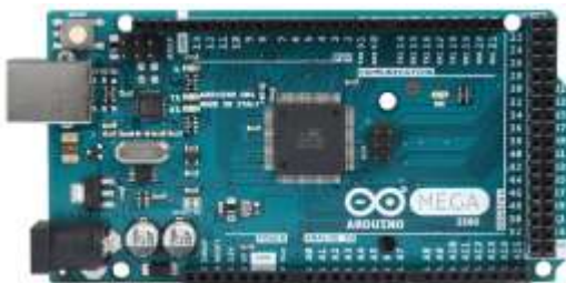
รูปที่ 6 ตัวควบคุมลูกด้วยโปรโตคอลมอดบัส RTU
